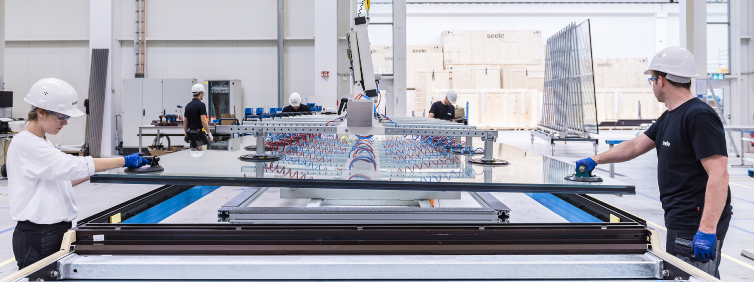
Zusammenbau von bis zu ca. 7 x 4 m großen SCF-Elementen für das Principal Place Commercial in London. (Bild: René Müller, seele GmbH) Titelbild: Das Principal Place Commercial in London. (©seele)
